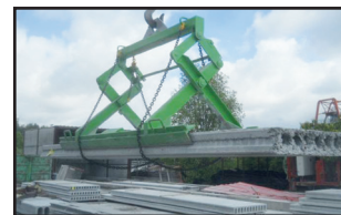
VS <6m et >60cm de large = utiliser la pince de 2m
